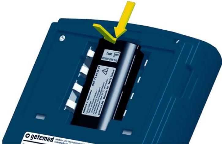
*Abb. 10 Pfeile zeigen die Einlegerichtung des Blockakkus.*
